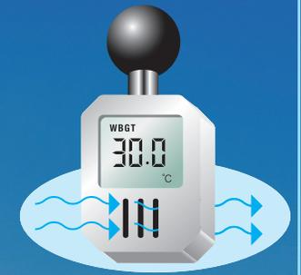
日向では計測器自体が熱くなりやすく、正確な温湿度を計測するには、計測器内部に熱をこもらせないように、常に外気を取り入れるための通気口が必要となります。
